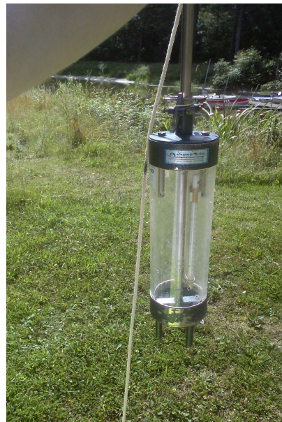
Water sampler (Sydvatten project)
