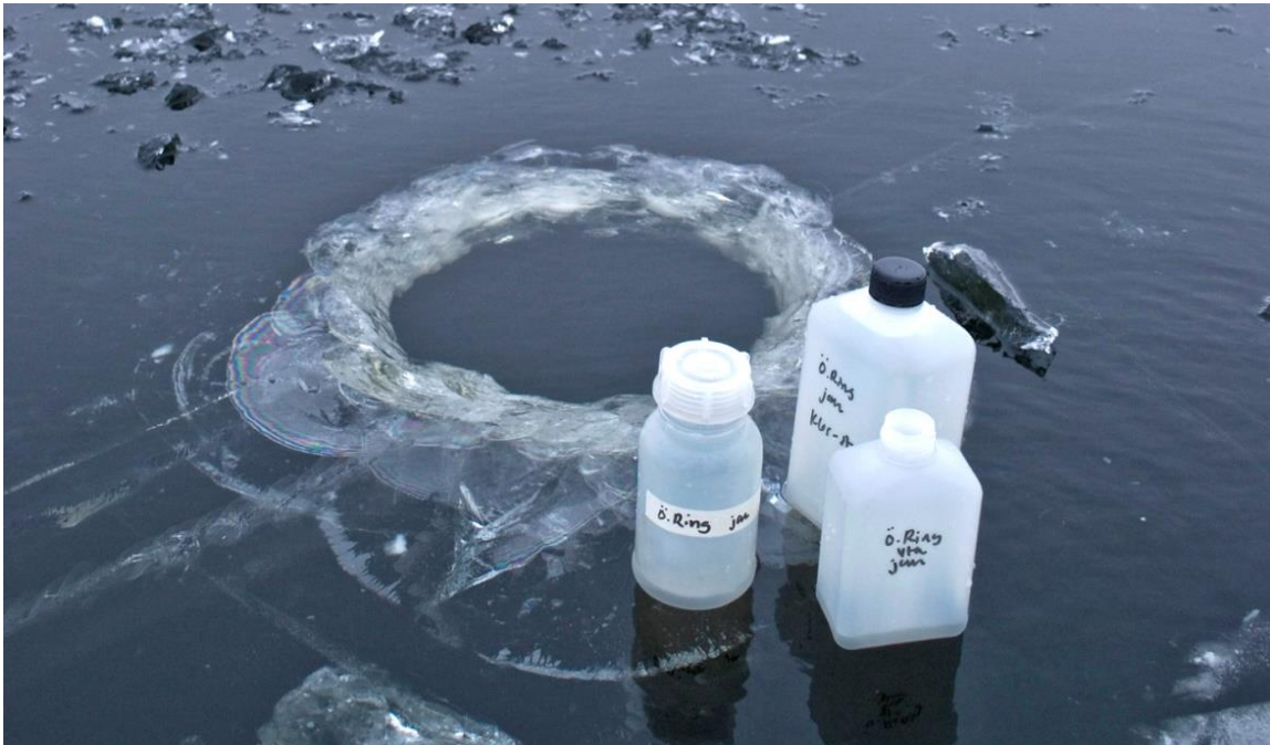
Figur 4. I Ringsjön tas prover på tre ställen för analys av vattenkemi en gång/månad inom recipientkontrollen (SRK).
