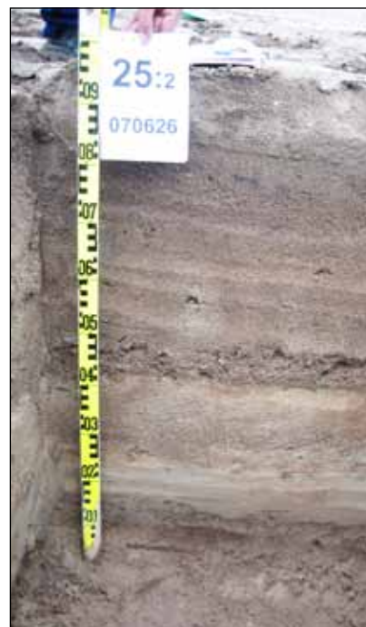
Figur 7-1 Kornstorleken varierar i olika skikt i dammarnas botten.
